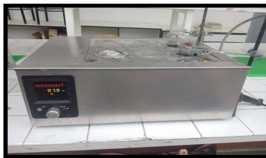
Figure 4.6 : L'incubation de la suspension dans un bain marie à 100 °c.
